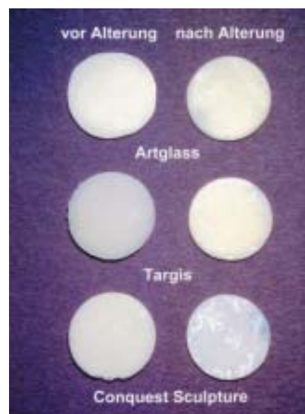
Abbildung 2 Photographische Darstellung der Ausgangsproben und der künstlich gealterten Proben für die Kompositmaterialien AG1, TG110 und CQ1
